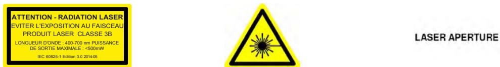
(a) Exemple d'étiquette de classification laser (b)Étiquette d'avertissement laser (c) Identification de l'ouverture du laser
