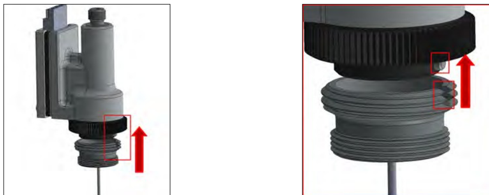
(a) Insertion du corps du microscope dans la canule d'imagerie (b) Insertion de la clé du microscope dans la fente de la canule
