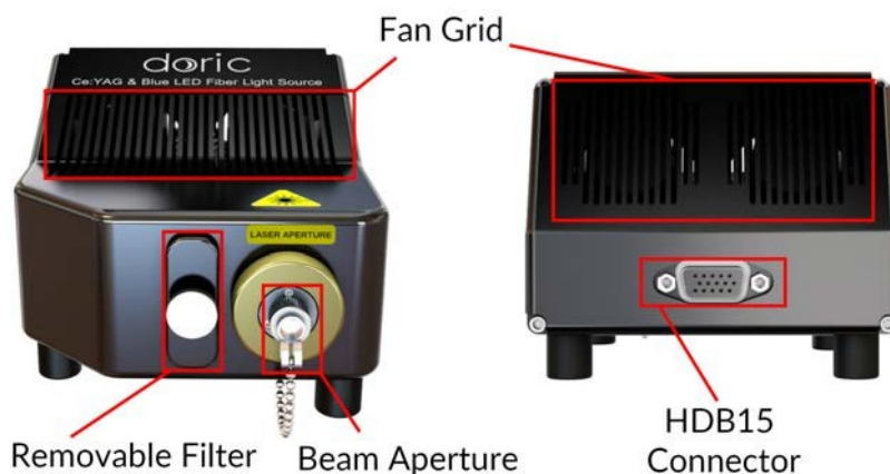
Figure 2.9 : Tête optique Ce:YAG + DEL
