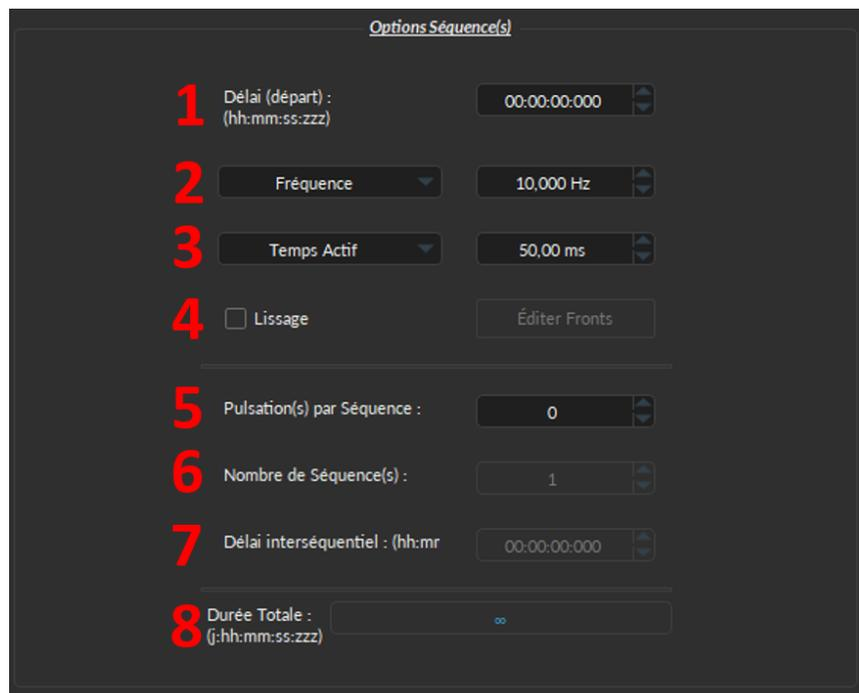
Figure 4.16 – Fenêtre de configuration du canal de la source lumineuse, options de séquence carrée
