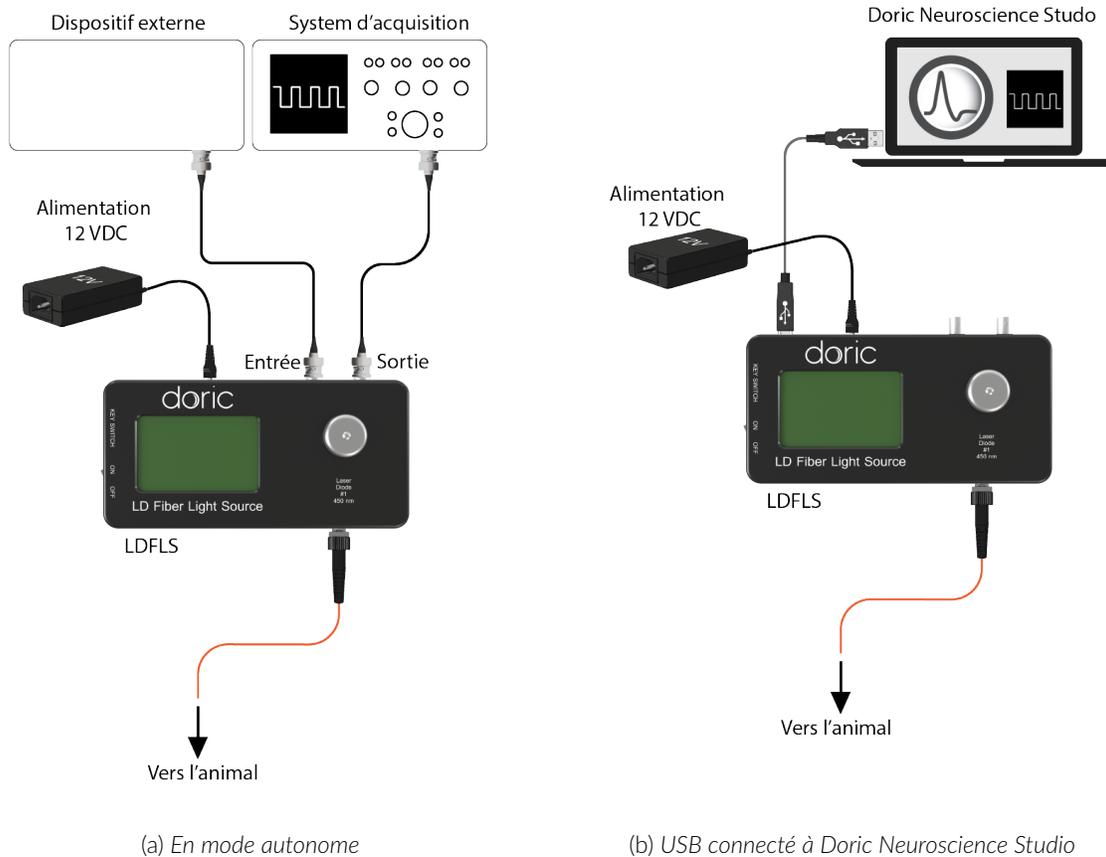
Figure 3.1 – Connexions d'une source laser fibrée
