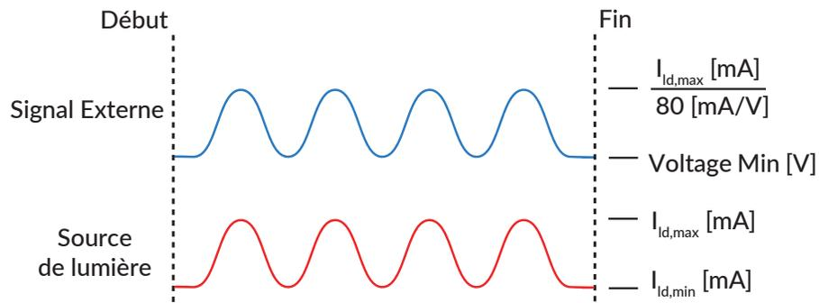
(b) Tension ajustée au courant maximum
