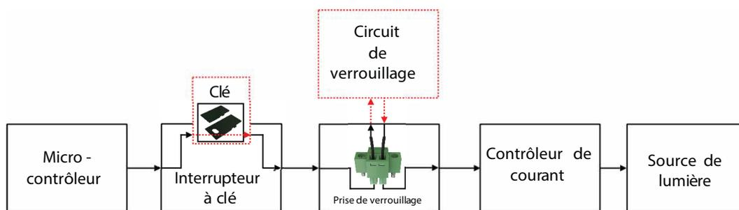
Figure 1.2 – Schéma fonctionnel de sécurité
