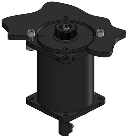
(a) Exemple de fixation avec trous de 6,8 mm
