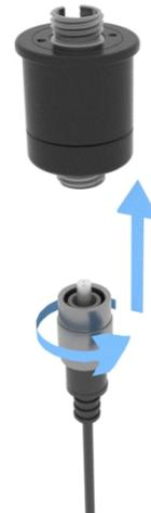
(b) Branchez la fibre optique dans le FRJ-1x1
