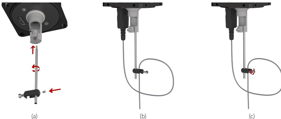
Figure 2.3 – Tige d'extension pour joint rotatif et fixation de la boucle
