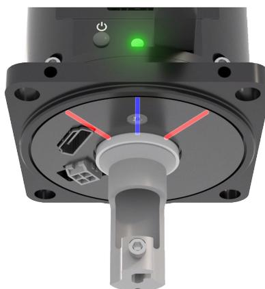
Figure 2.4 – La position du capteur de couple est relative au **Centre** (en bleu), pour la **gauche**, et la **droite** (en rouge). En position de **Centre**, le joint rotatif ne bouge pas.
