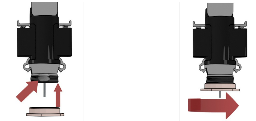
(a) Placer des gouttes de colle dans le filetage de la canule. (b) Enfiler l'anneau de réglage de la protrusion sur la canule.
