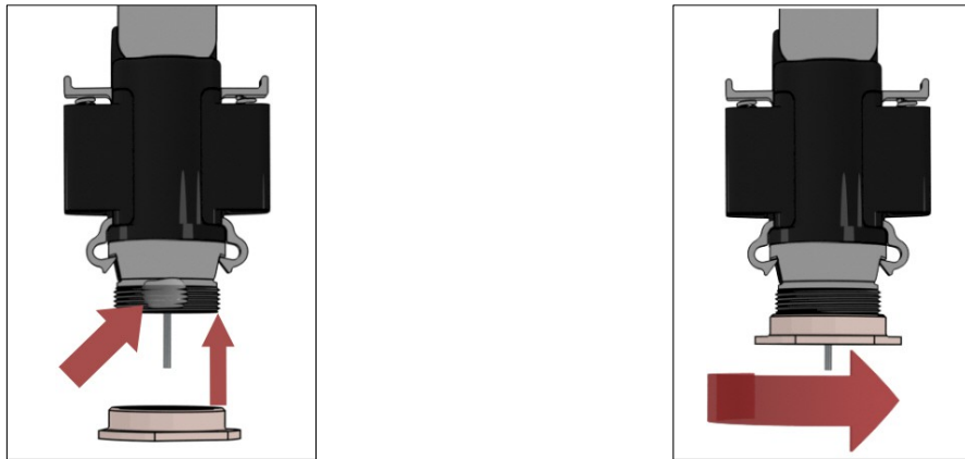
(a) Placer les gouttes de colle dans le filetage de la canule. (b) Enfiler la bague de réglage de la saillie sur la canule.
