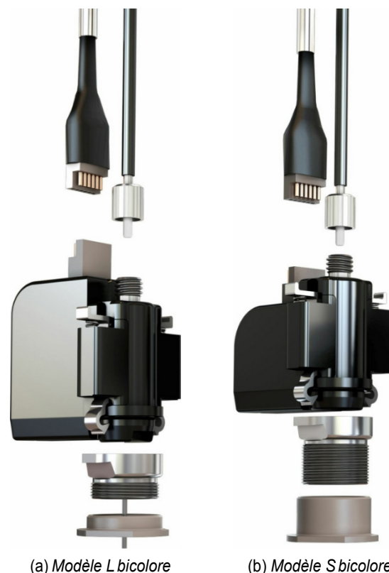
Figure 1.1 : Microscopes à fluorescence miniatures en format éclaté
