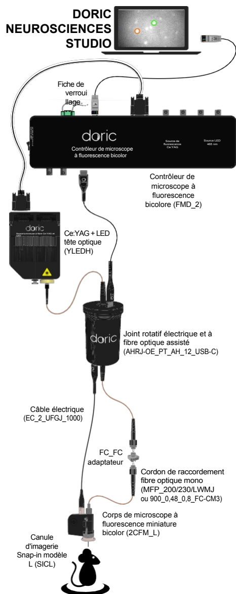
(b) Configuration libre de mouvement pour l'imagerie du cerveau profond en deux couleurs
